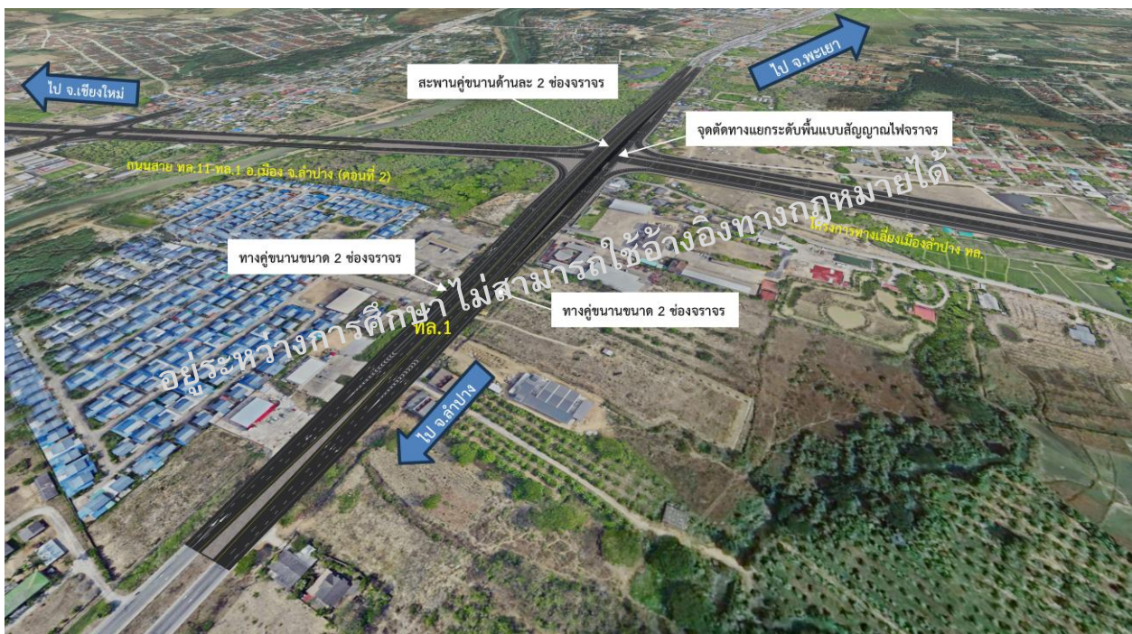
รูปที่ 6-20 รูปแบบทางเลือกที่ 1 : สะพานข้ามแยก (Flyover Bridge) ในแนวทางหลวงหมายเลข 1 แบบ 2 ทิศทาง + จุดตัดทางแยกระดับพื้นปรับปรุงเป็นแยกสัญญาณไฟจราจร
