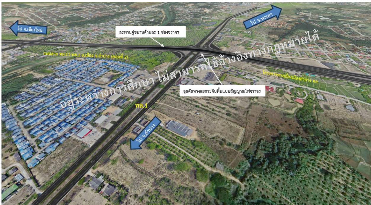
รูปที่ 6-26 รูปแบบทางเลือกที่ 3 : สะพานข้ามแยก (Flyover Bridge) ในแนวถนนสายแยก ทล.11 - ทล.1 (ตอนที่ 2) แบบ 2 ทิศทาง + จุดตัดทางแยกระดับพื้นปรับปรุงเป็นแยกสัญญาณไฟจราจร
