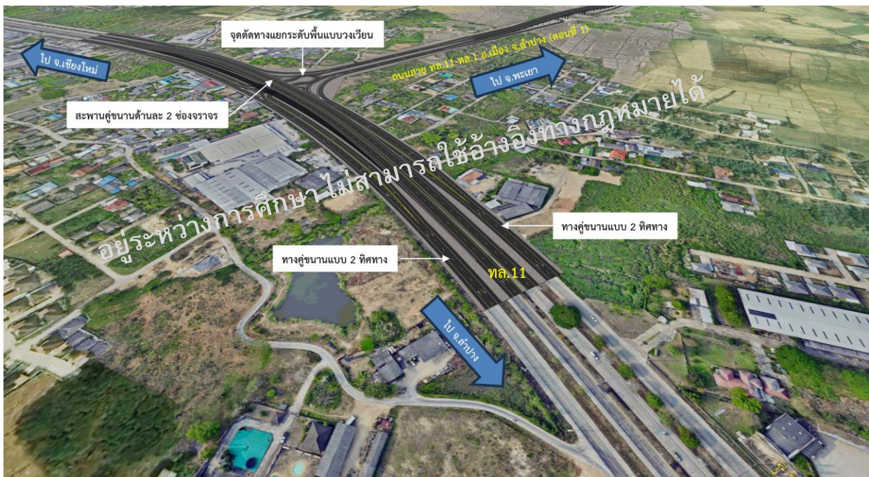
รูปที่ 6-8 รูปแบบทางเลือกที่ 1 สะพานข้ามแยก (Flyover Bridge) ในแนวทางหลวงหมายเลข 11 แบบ 2 ทิศทาง + จุดตัดทางแยกระดับพื้นปรับปรุงเป็นวงเวียน + ถนนคู่ขนานเป็นแบบ 2 ทิศทาง
